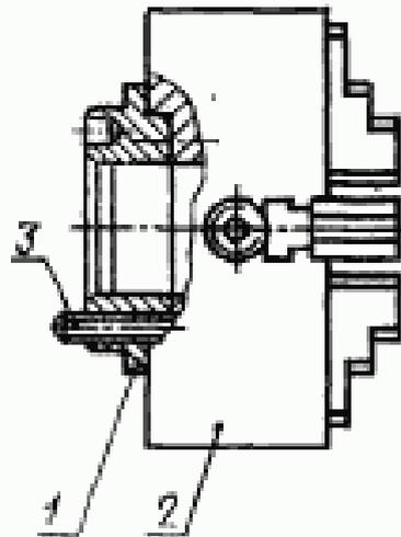
1 — фланец промежуточный по черт. 6, 7 и табл. 3; 2 — патрон четырехкулачковый с независимым перемещением кулачков по ГОСТ 3890; 3 — винт по ГОСТ 11738
