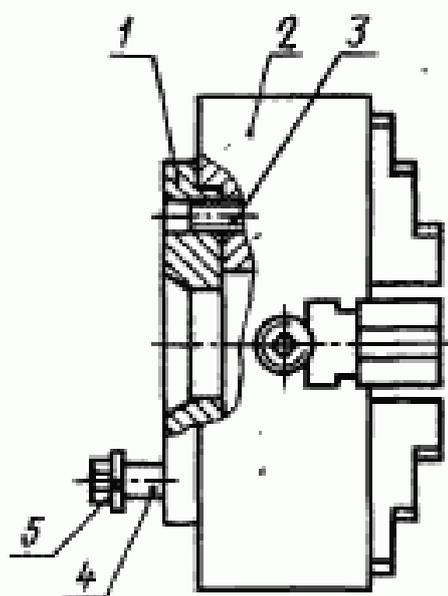
1 — фланец промежуточный по черт. 4 и табл. 2; 2 — патрон четырехкулачковый с независимым перемещением кулачков по ГОСТ 3890; 3 — винт по ГОСТ 11738; 4 — винт по ГОСТ 12593; 5 — гайка по ГОСТ 12593
